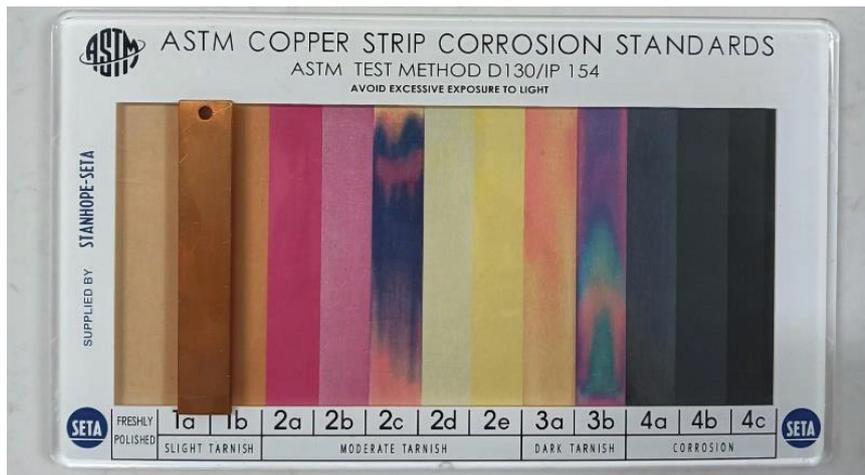
Gambar 1. Hasil perbandingan strip tembaga dengan ASTM *copper strip corrosion standards*
