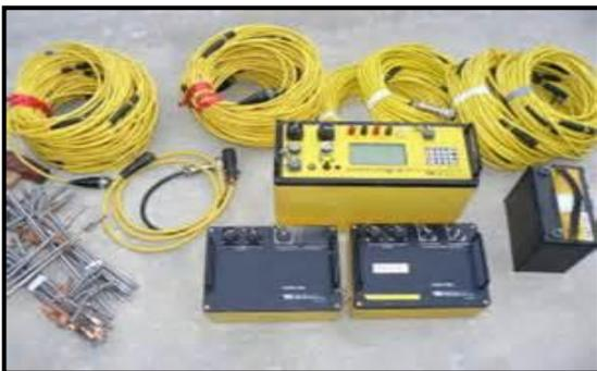
Gambar 6. Peralatan Geolistrik Multichannel Supersting R8/IP dengan 56 elektroda
