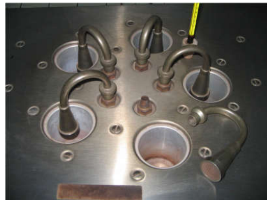
Gambar 2 : Lubang tempat penguapan gelas beker pada alat uji evaporator Bath Existent Gum
