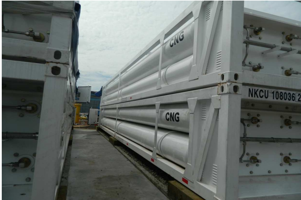
Gambar 9 Skid tube CNG yang diangkut dengan truk dan kapal
