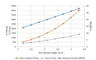
Gambar 2. Grafik Performa Parameter Turbin
