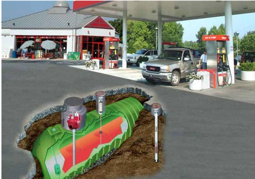
Gambar 5.2. Tangki pendam, sumur pantau dan dispenser
