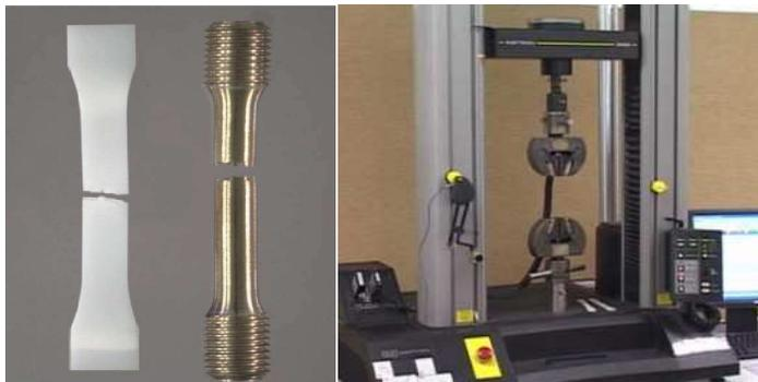
Gambar 1. Spesimen dan alat pengujian uji tarik
