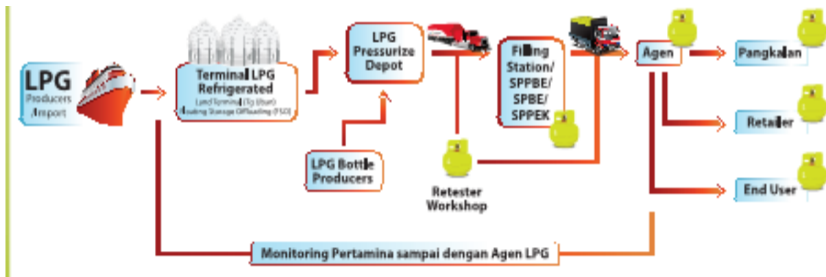
Gambar III.9. Sistem suplai dan distribusi LPG Pertamina (sumber : Buku Pintar Petunjuk Aman Penggunaan Elpiji 3 Kg Pertamina)
