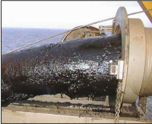
Gbr 7 Deposisi Wax dari dalam pipa (sumber: http://www.hydrafact.com )
